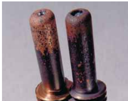
Elektrode nach normalem Einsatz, Elektrode nach übermäßigem Einsatz
