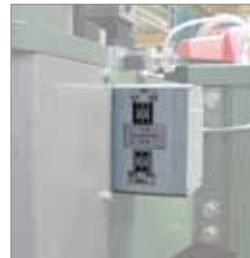
PROGRAMMWAHL- SCHALTER zur Vorwahl der Schweißprogramme
