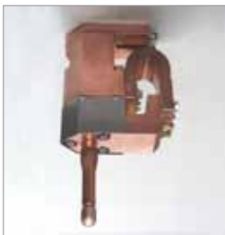
HYDRAULISCHES SCHWEISSELEMENT (Ausgleichselement)
