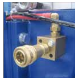
SCHNELLKUPPLUNG Wasseranschluss für Schweißwerkzeuge
