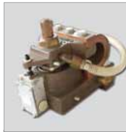
FOLGEELEKTRODEN- HALTER (für besseres Nachsetzverhalten der Elektrode)
