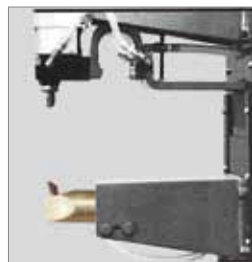
ROHRARM als untere Punktarmatur
