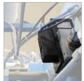
PROPORTIONALVENTIL mit Absenksicherung und Elektrodenkraftüberwachung
