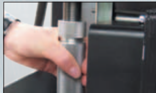
Leicht verstellbare Öffnungsbegrenzung der Oberarmatur
