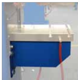
PRESSENTISCH zur Aufnahme der Spannplatte unten
