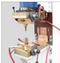
SCHNELLWECHSEL- SYSTEM für schnellen Werkzeugwechsel
