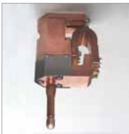
HYDRAULISCHES SCHWEISSELEMENT (Ausgleichselement)
