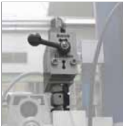
DRUCKLOSES ABSENKEN der Oberarmatur über Handventil am Zylinder
