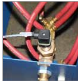
DURCHFLUSSWÄCHTER (Wasserkontrollschalter) im Wassereingang angeordnet
