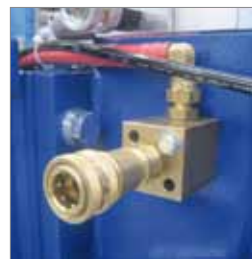
SCHNELLKUPPLUNG Wasseranschluss für Schweißwerkzeuge
