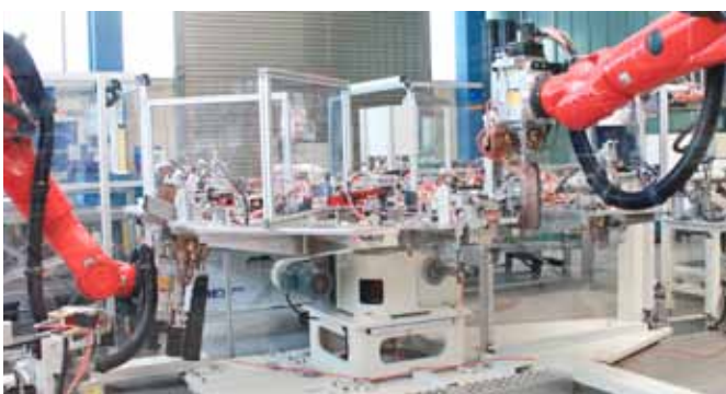
Roboter-Schweißanlage zum Schweißen von Automobilteilen Robot welding cell for spot welding of automotive body parts
