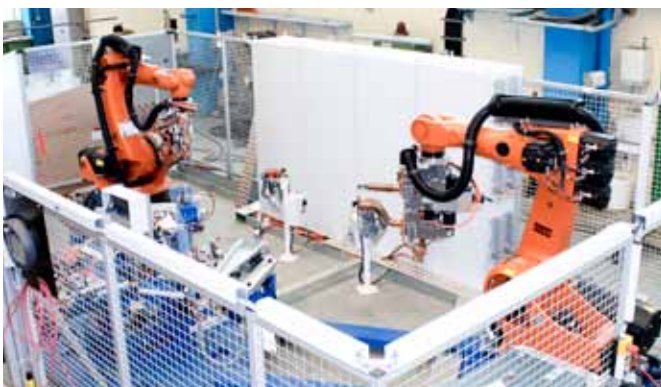
Roboter-Schweißanlage zum Schweißen von Verstärkungsblechen Robot welding cell for spot welding of reinforcement plates
