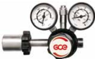
Flaschendruckminderer, einstufig. Mit hoher Durchflussleistung. Für die Versorgung von Lasern mit Prozessgasen der Reinheit bis 5.0, Eingangsdruck max. 300 bar. Ausgangsdruck bis 40 bar (N<sub>2</sub>) /13 bar (O<sub>2</sub>/Ar/CO<sub>2</sub>). Ausgang G 1/2" EN 560 Außengewinde.
