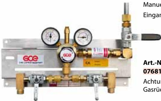
Zweiflaschenstation 1x2 oder 2x1 Flasche mit Sicherheitseinrichtung nach EN 730-1 auf der Niederdruckseite. Diese Station besitzt keine automatische Schnellschlusseinrichtung. Manuelle Umschaltung zum einfachen Wechsel der Gasvorräte. Einfache Wandmontage
