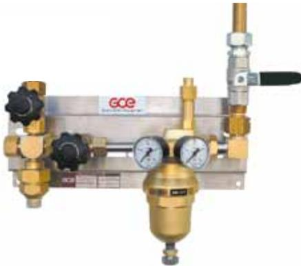
Druckregelstation für 1 Flasche oder Bündel. Mit Spül-/Entlastungsventil, Gasrücktrittsventil und Filter am Eingang. Eingang: W 21,8 × 1/14". Ausgang: 3/4" Kugelhahn.
