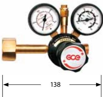
Acetylen-Druckminderer. Membran UC 500: EPDM Gummi. Eingang: M24 × 1,5, Ausgang: G 1/2" l.h.
