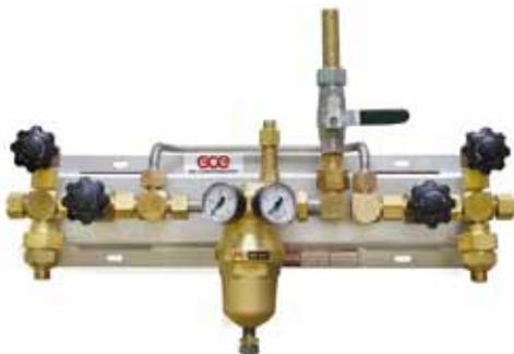
Druckregelstation für 2 Flaschen oder Bündel. Mit Spül-/Entlastungsventil, Gasrücktrittsventil und Filter am Eingang. Eingang: W 21,8 × 1/14". Ausgang: 3/4" Kugelhahn.
