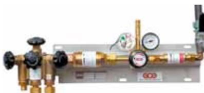
Druckregelstation für Acetylen mit Kontaktmanometer. Für Flaschen- und Bündelversorgung geeignet. Die Stationen sind mit einer selbsttätigen Schnellschlusseinrichtung und Zerfallsperre ausgerüstet. Signalkasten gehört nicht zum Lieferumfang.
