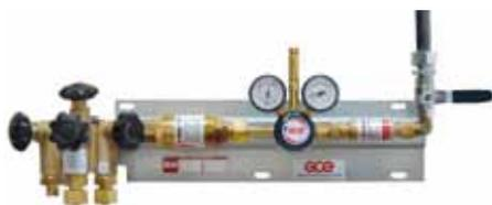
Zum stationären und mobilen Einsatz. Zum Einsatz bei Einzelflaschen oder Flaschenbündel. Die Stationen erfüllen die Forderung der TRAC. Durch die Verwendung einer Zerfallsperre und einer automatischen Schnellschlusseinrichtung kann diese Station sowohl für Flaschen-, als auch für Bündelbetrieb eingesetzt werden. Eingang: W21,8x1/14"l.h., Ausgang: Kugelhahn 1/2".
