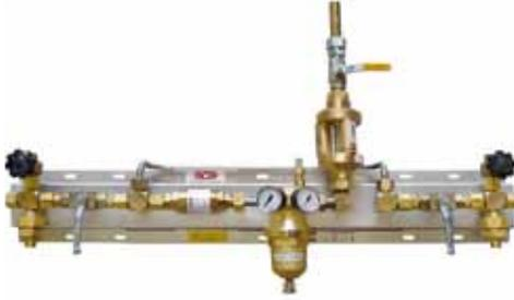
Beidseitige Acetylen- Druckregelstation bis 25 bar für 2 Flaschenbündel. Diese Station verbindet optimale Sicherheit mit hoher Wirtschaftlichkeit unter Berücksichtigung der EN ISO 14114. Ausführung in robuster Bauweise. Einfache Wandmontage! Mit Sicherheitseinrichtung nach DIN EN 730-1. Diese Station ist mit einer selbsttätigen Schnellschlusseinrichtung, Zerfallsperre sowie Gasrücktrittventil ausgerüstet. Geeignet für die Bündelversorgung. Eingang: W21,8x 1/14" l.h., Ausgang : Kugelhahn 3/4".
