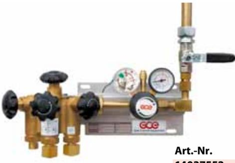
Druckregelstation mit Kontaktmanometer. An dem verstellbaren Kontaktmanometer kann für die Hochdruckseite der Signalpunkt eigenständig gewählt werden. Mittels Signalkasten wird das Alarmsystem komplettiert. Signalkasten gehört nicht zum Lieferumfang
