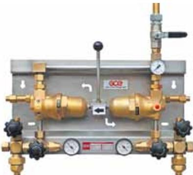
Diese Station schaltet automatisch und ohne Hilfsenergie von der entleerten auf die volle Bündelseite. Dadurch wird gewährleistet, daß durch Bündelwechsel die Produktion nicht unterbrochen werden muß. Gasrücktrittventile und Druckentlastungsventile erhöhen die Betriebssicherheit.
