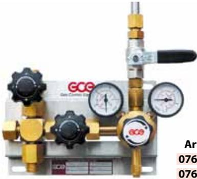
Druckregelstation, mit Spül-/Druckentlastungsventil zum einfachen Lösen der Flaschen-/ Bündelanschlußschläuche. Für 1 Flasche oder 1 Bündel. Mit Gasrücktrittventil im Eingang. Zur Wandmontage als auch zum Einhängen am Bündel geeignet.
