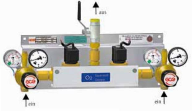
Einstufig, für Flaschen- oder Bündel-Versorgung. Für die Versorgung mit technischen Gasen sowie Laser-Prozessgasen. Mit vollautomatischer Umschaltung für unterbrechungsfreie Gasversorgung und Magnetventilen für maximalen Flow. Steuergerät inkl. akustischer und optischer Gasmangelsignalisierung für Magnetventilumschaltung.
